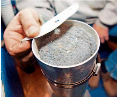
**10** | *Den Schnitt verputzen, dann die Späne vom Schaumstoffpfropfen saugen und diesen nach oben herausziehen*
