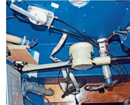
**2** ... hilft beim Bestimmen der Einbauposition des Antriebs. Eine Pappschablone für das Gegenlager erstellen
