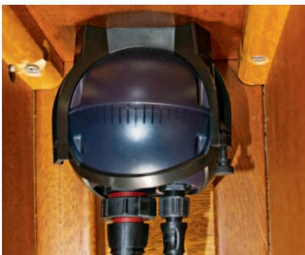
**14** | *Der Kompass- und Beschleunigungssensor sollte nahe der Schiffsmitte eingebaut werden, er sitzt unter dem Salontisch*
