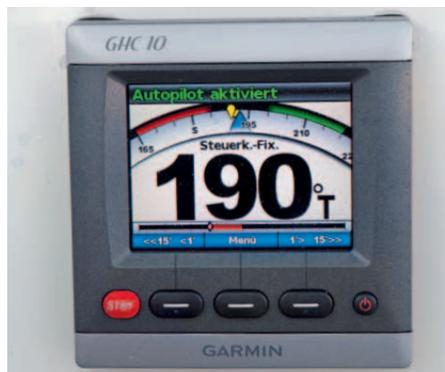
**15** | *Das Instrument arbeitet mit NMEA-2000-Bus, benötigt aber eine zusätzliche Steuerleitung, um den Antrieb zu aktivieren*
