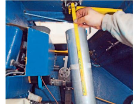
**6** Die Schnitthöhe wird von außen nachgemessen. Da beim Sägen keine Metallspäne in das untere Lager fallen sollen, ...
