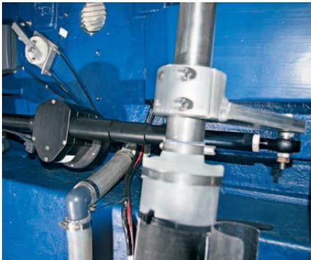
**12** | *Nun wird der Anlenkhebel angebracht. Der Koker endet weit über der Wasserlinie, die Dichtmanschette ist nicht zwingend*
