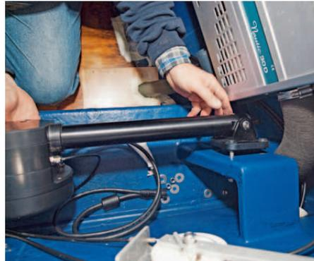
**11** | *Den Antrieb an das Gegenlager schrauben. Wir haben ihn parallel zur Ruderwelle montiert, so arbeiten die Gelenke weniger*
