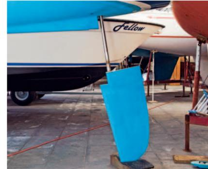
**4** Um den Anlenkhebel zu montieren, muss das Kokerrohr abgesägt werden. Dazu wird das Ruder abgesenkt
