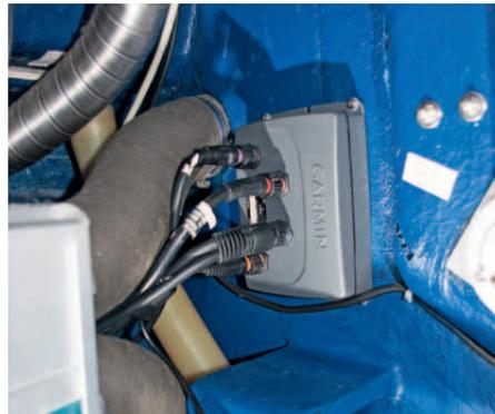
**13** | *Die Endstufe des Autopiloten ist wasserdicht, muss aber in der Nähe des Antriebs installiert werden*
