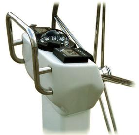
Die Jefa RP300 Steuersäule ist mit Schubstangen der Serie 300 ausgerüstet. Das Steuersystem ist für Yachten bis 50' Länge einsetzbar ( bei Schiffen über 45' empfehlen wir ein großes Steuerrad). Die 25 mm Steuerwelle ist aus Nickel-Alu-Bronze und mit dem Branchenüblichen 1" Konus versehen. Der Konus wird für alle Jefa Räder bis zu 1500 mm Durchmesser eingesetzt.
