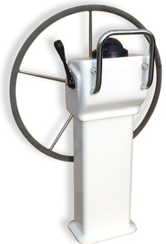
Die Jefa RP200 Steuersäule ist mit Schubstangen der Serie 200 ausgerüstet. Das Steuersystem ist für Yachten bis 50` Länge einsetzbar ( bei Schiffen über 45` empfehlen wir ein großes Steuerrad). Die 25 mm Steuerwelle ist aus Nickel-Alu-Bronze und mit dem Branchenüblichen 1" Konus versehen. Der Konus wird für alle Jefa Räder bis zu 1500 mm Durchmesser eingesetzt.
