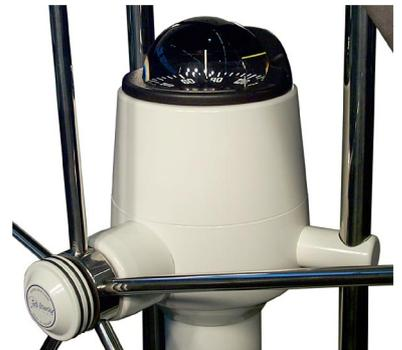
Die Jefa RP 100 Steuersäule ist mit Schubstangen der Serie 100 ausgestattet. Das Steuersystem ist für Yachten bis 50` Länge einsetzbar ( bei Schiffen über 45` empfehlen wir ein größeres Steuerrad). Die 25mm Steuerwelle ist aus Nickel- Alu- Bronze und mit einem branchenüblichen 1" Konus versehen. Der Konus wird für alle Jefa Räder bis zu 1500mm Durchmesser eingesetzt. Die Steuerwelle ist mit zwei maximal weit voneinander entfernten Kugellagern ausgestattet.
