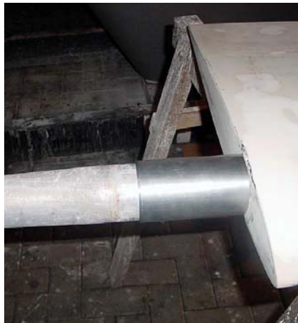
Die Jefa Ruderlagerbuchse stellt wieder eine perfekte Lageroberfläche her. Sie wird mit andgedicktem Epoxydharz auf die Welle geklebt.
