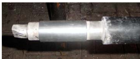
Der gleiche Vorgang wiederholt sich am oberen Ende der Ruderwelle für das Toplager.
