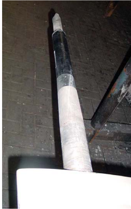
Das Ruder liegt ausgebaut unter dem Schiff. Gut zu erkennen, der eingelaufene Ruderschaft.
