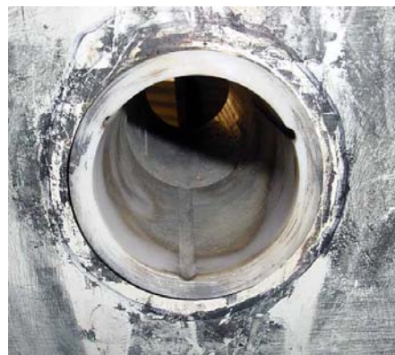
Die Jefa Lager haben einen größeren Aussendurchmesser als das alte Lager.
