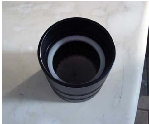
In diesem Falle wird ein Jefa Typ J-41000 Lager montiert.
